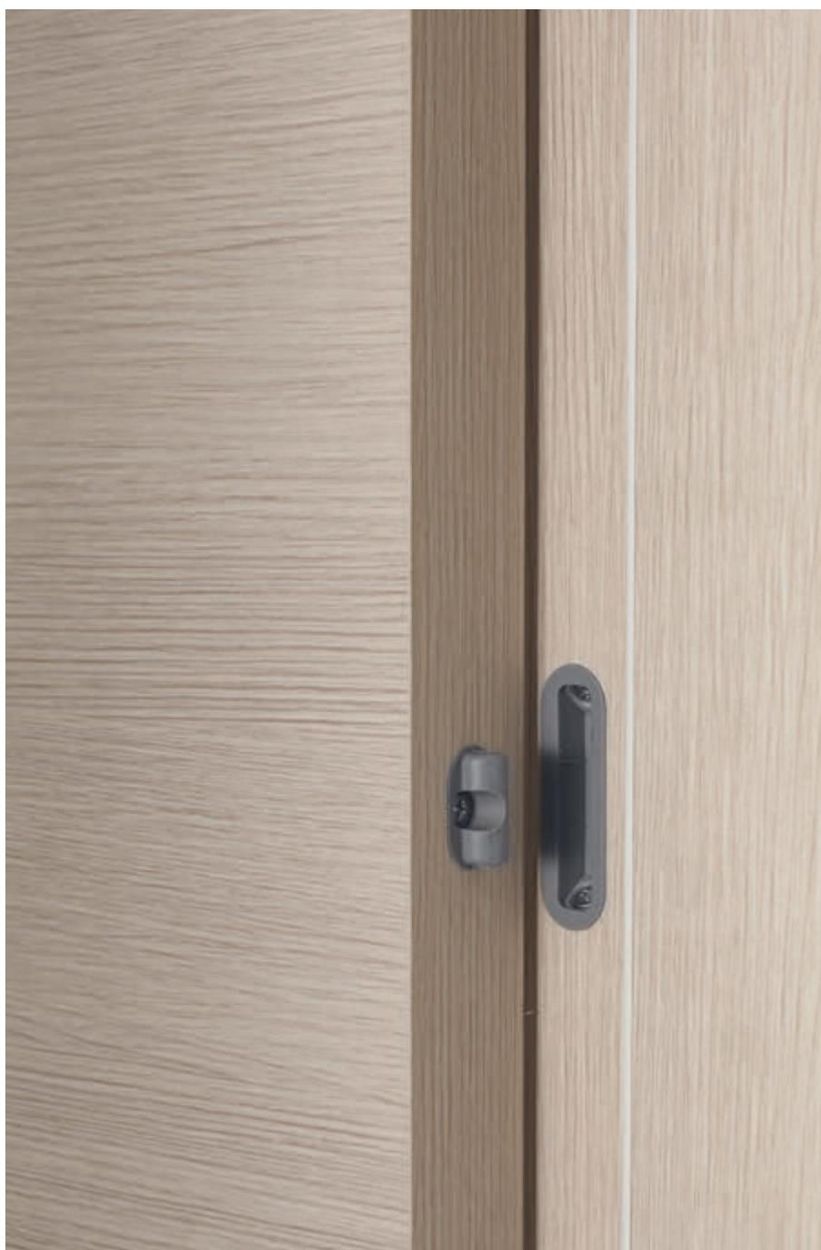
Il rostro centrale dal lato cerniera permette alla porta in chiusura di rimanere sempre in tensione evitando imbarcamenti. / The central protruding pin on the hinged side allows the door panel to remain firm when closed.
