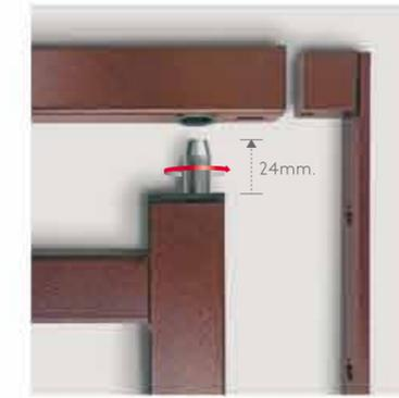
Le staffe di fissaggio a muro si inseriscono nel tubolare 30 x 40 e consentono una regolazione in larghezza di +/- 15 mm.
